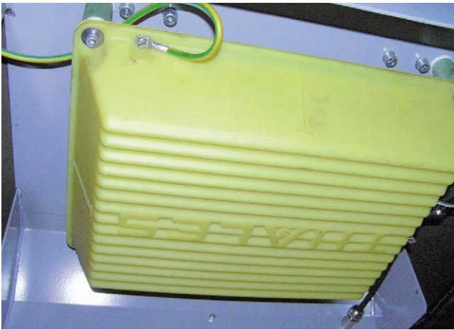
Obr. 8 Anténa na čítanie dát z balíz
