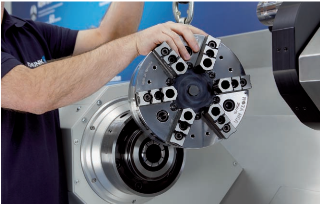
SCHUNK ROTA FSW umožňuje rýchlu výmenu skľučovadla pri vynikajúcej opakovateľnej presnosti
