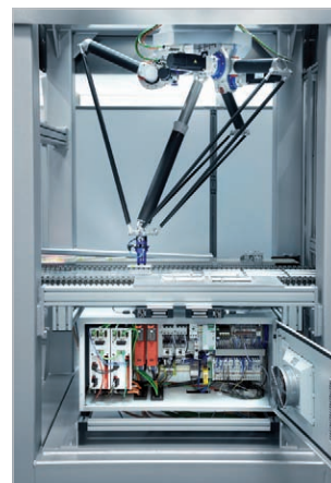
3D delta robot postavený na řízení a hardware Beckhoff (průmyslový počítač, servopohony a distribuované periferie)
