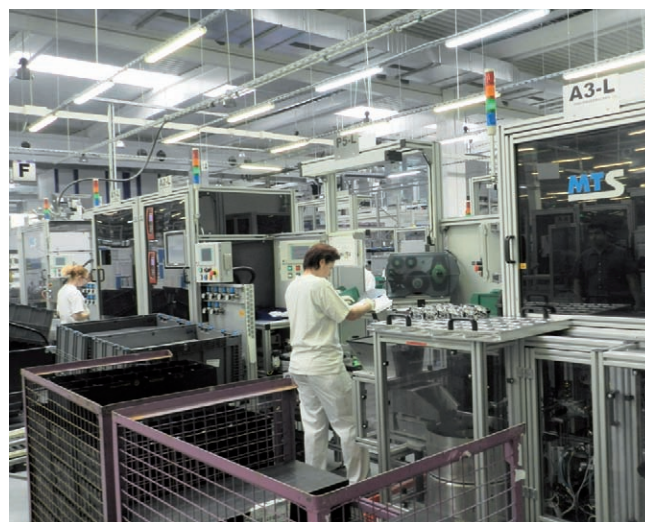
Obr. 4 Na montážnych linkách sa spolu zmontujú plastové a elektronické diely
